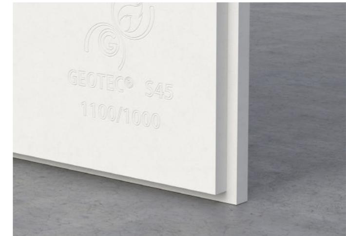
Les plaques coupe-feu **GEOTEC® S45** de dimension **0,20 x 1,00 ml jusqu'à 1,10 x 1,00 ml**, d'épaisseur 45mm sont des produits incombustibles composés principalement de plâtre renforcé de fibre de verre (**GRG : Glass Reinforced Gypsum**), ce qui leur confère une excellente résistance mécanique. Ces plaques sont spécialement conçues avec des feuillures afin de permettre leur emboîtement et faciliter leur assemblage.
